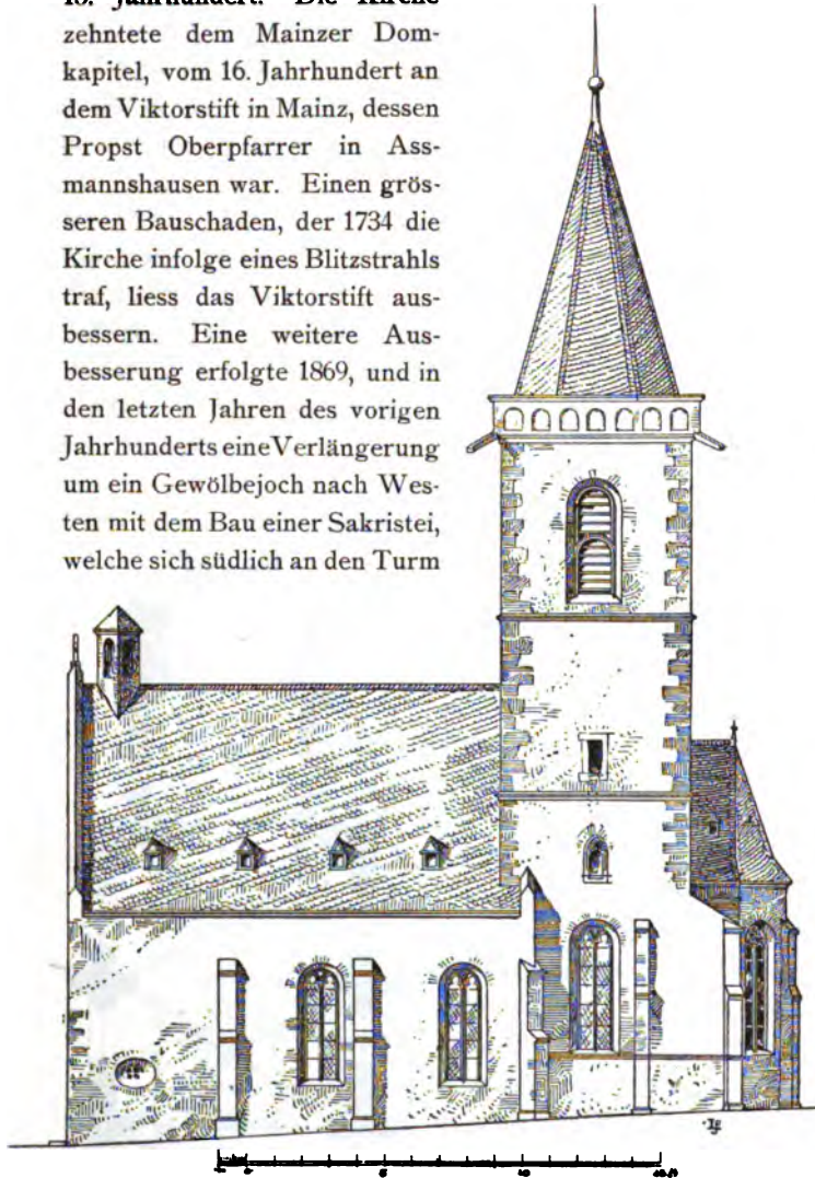
Fig. 125. Assmannshausen. Pfarrkirche. Südseite vor dem Umbau.
